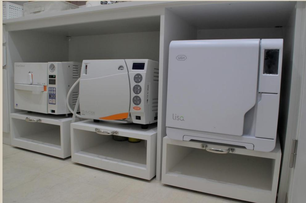
オートクレーブ(高圧蒸気滅菌機)
